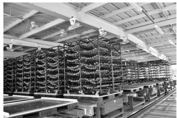
自然乾燥循環装置
