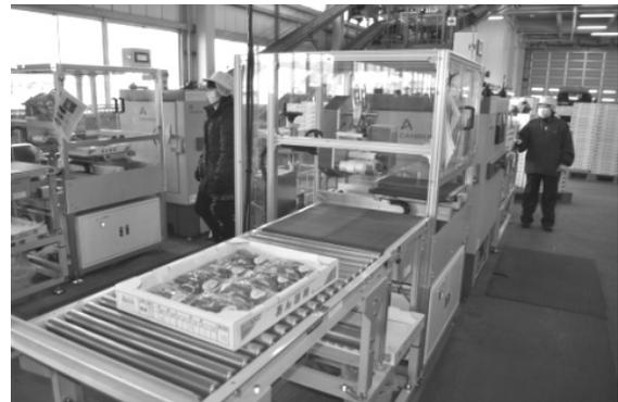
導入された非破壊検査機器
