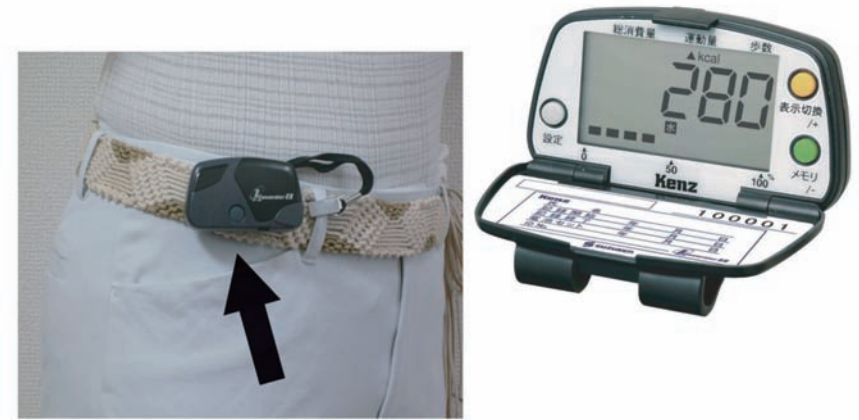
(図1) 加速度センサー付身体活動計 (活動量計)
