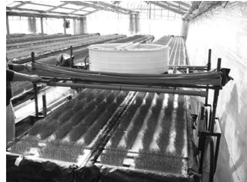
図7. 障がい者のために開発した防除機械
